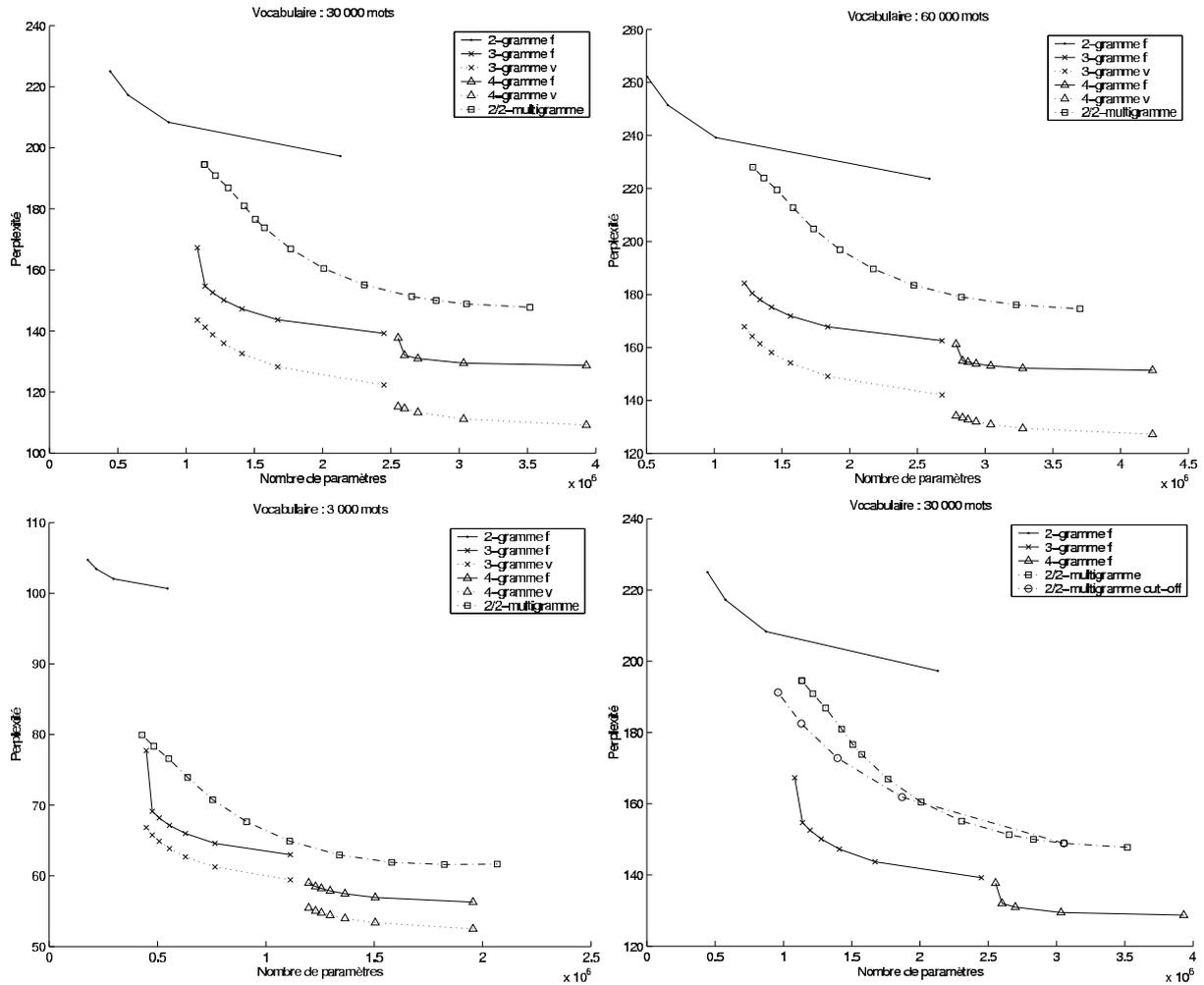
Figure 1: Comparaison de l'influence du nombre de paramètres sur la perplexité des modèles de  $n$ -gramme à horizon fixe ( $n$ -gramme-f) ou variable ( $n$ -gramme-v) pour  $n \in [2, 4]$ , et du 2/2-multigramme pour différentes tailles de vocabulaire, et influence sur la perplexité de la méthode de *cut-off* pour réduire les paramètres du modèle de 2/2-multigramme avec un vocabulaire de 30 000 mots.
